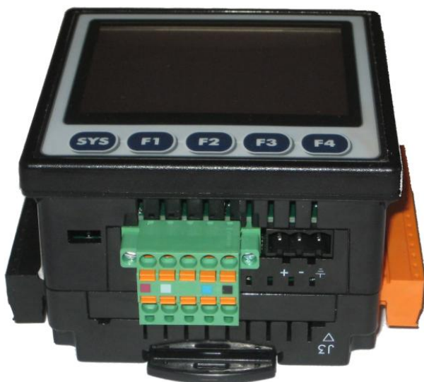
SINUSSTROM BMS Display
